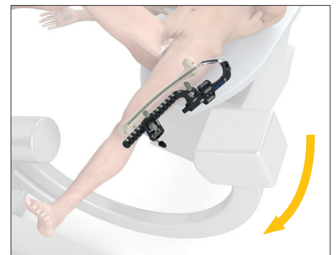
Fig. 75: Adjust C-arm down
